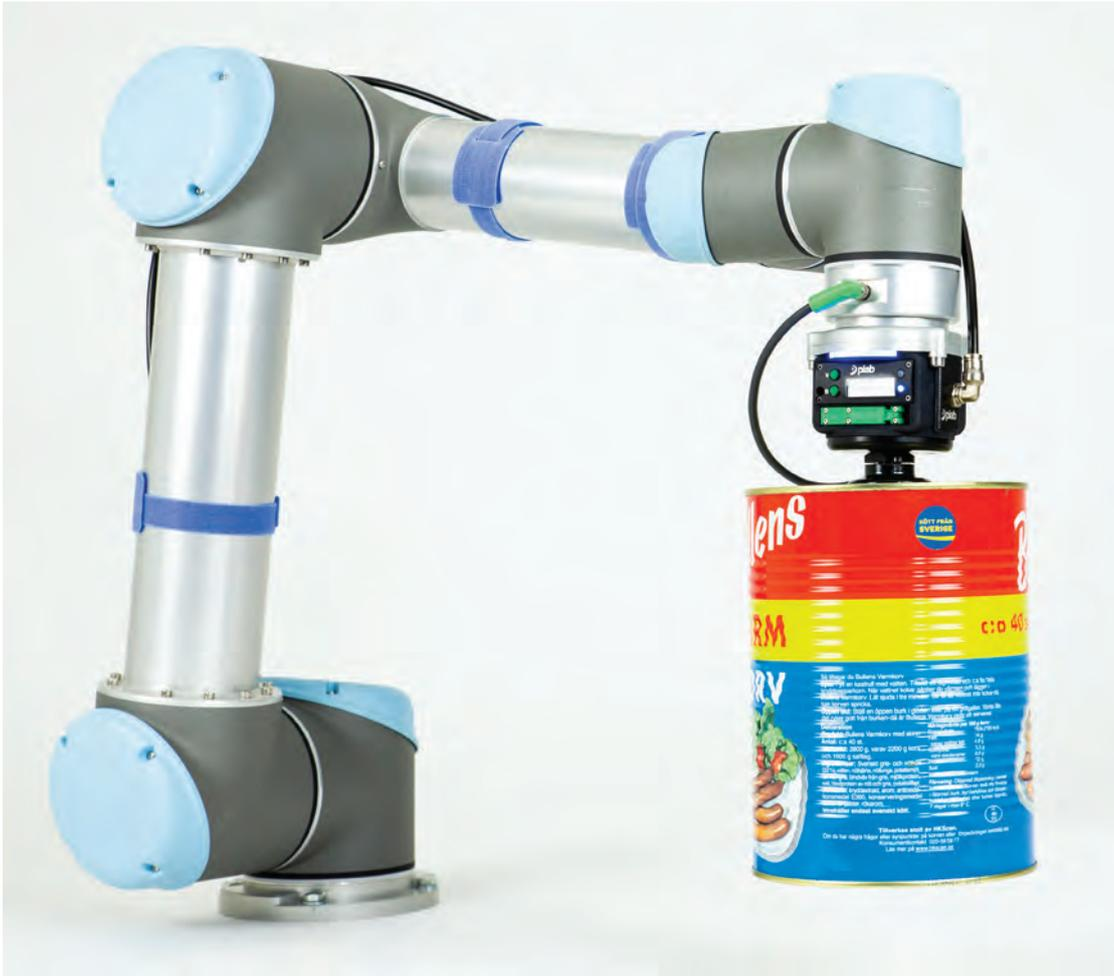
最大7kgのワークを吸着して吊り上げ可能。
