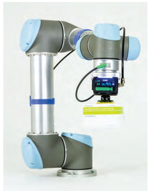
サクシオンカップを1個もしくは2個使用し、段ボール（リークが発生する素材）などを安全に吸着搬送。
